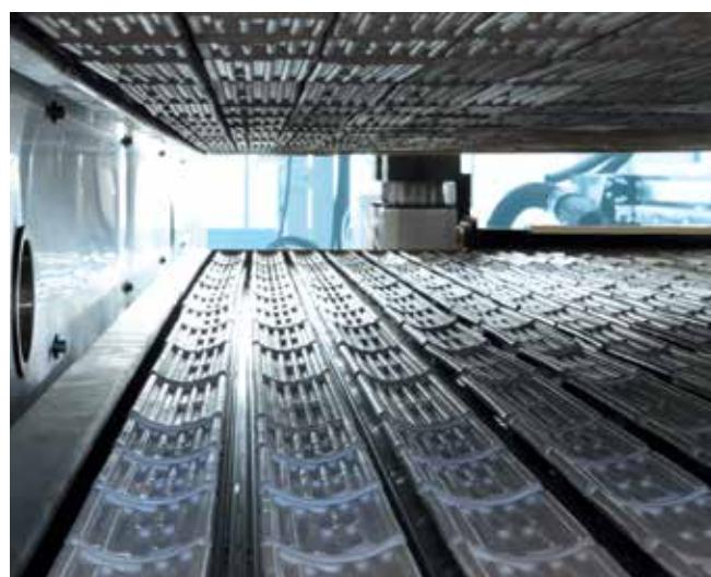
**Il movimento degli imbutitori** è ottenuto mediante servomotore (opt. sul modello FT 500) e garantisce una distribuzione uniforme e controllata del materiale all'interno delle cavità dello stampo. La possibilità di impostazione delle diverse velocità e dei tempi di intervento permettono di migliorare notevolmente l'aspetto estetico in presenza dei materiali trasparenti, riducendo la marcatura dei punti di contatto tra imbutitore e materiale.
