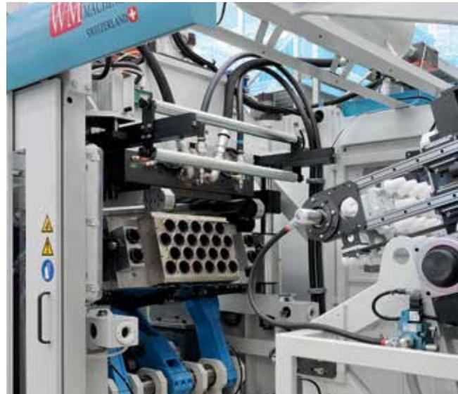
**Il controllo dei riscaldatori** a raggi infrarossi, avviene per file longitudinali indipendenti sia sul forno superiore che su quello inferiore. Sono inoltre disponibili svariate possibilità di parzializzazioni e controlli trasversali della temperatura che permettono di ottimizzare il ciclo di riscaldamento foglia in funzione dei diversi tipi di materiale da trattare. La lunghezza dei forni di riscaldamento è pari a sette volte il passo massimo di traslazione.
