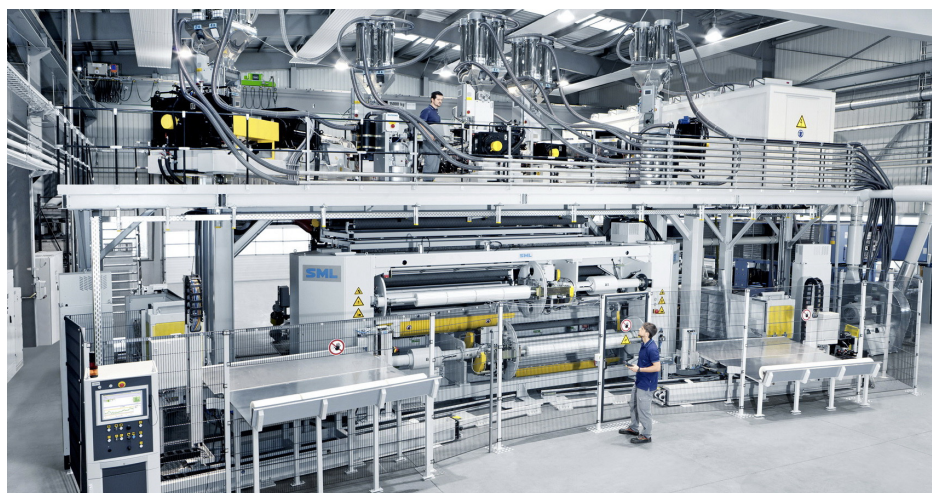
SML 兰精公司 SmartCast® 生产线采用的 W4000-4S 型收卷机
