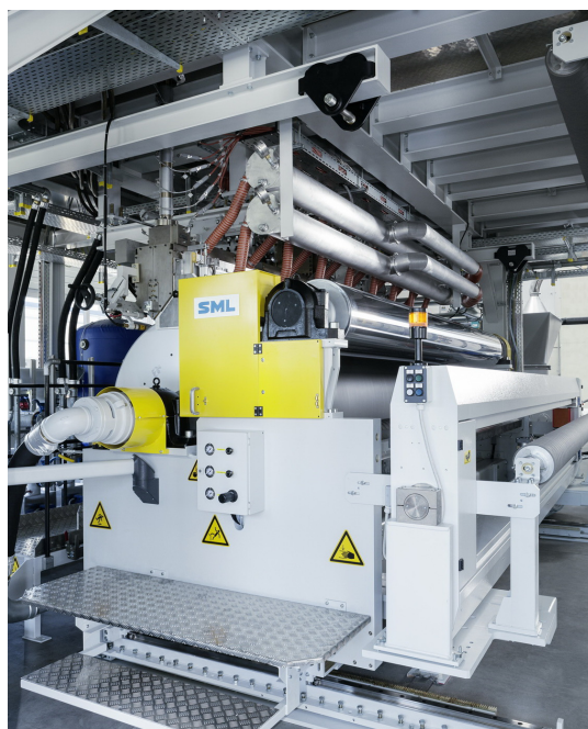
SML 兰精公司 SmartCast® 生产线的流延工作站
